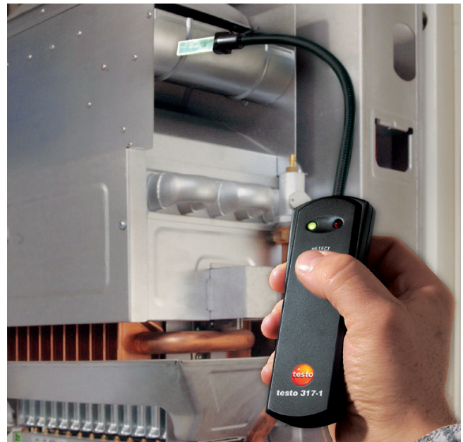
Utilizarea detectorului pentru scăpări de gaze testo 317-1
